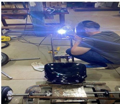
Figura 7 - Soldagem da Caixa de Direção
