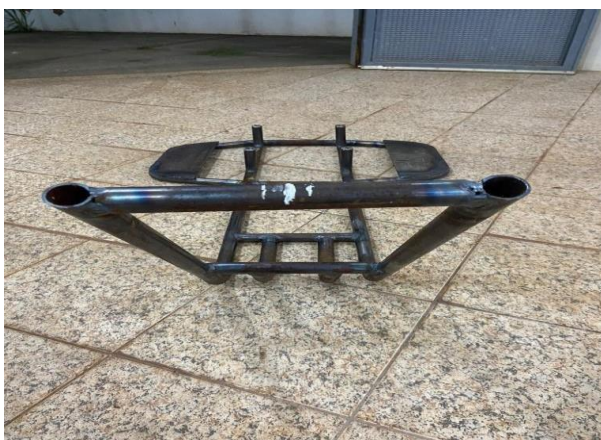
Figura 6 - Centralização para Soldagem da Caixa de Direção
