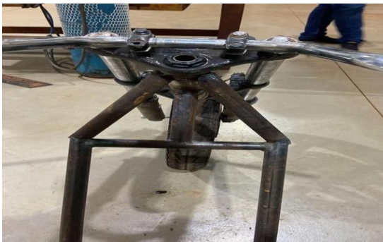
Figura 10 – Visão superior da Caixa de Direção
