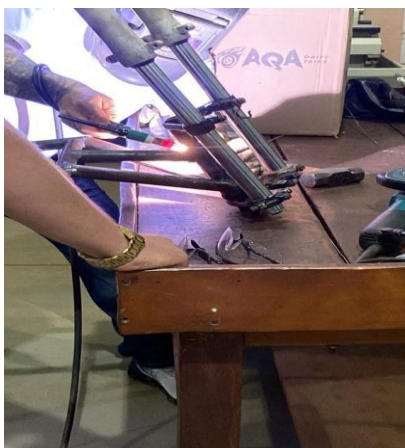
Figura 8 - Soldagem da Direção
