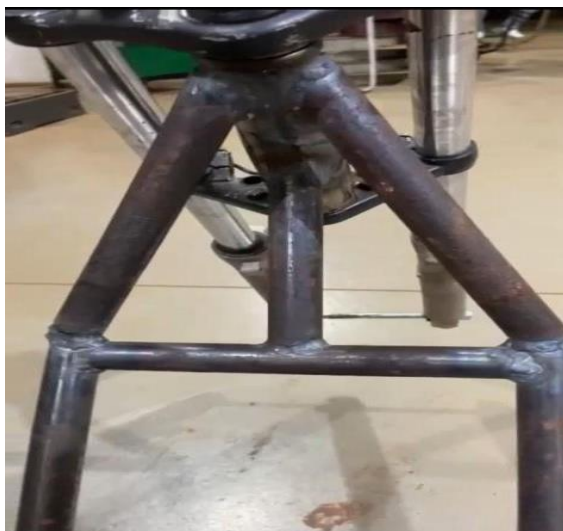
Figura 12 - Cabamendo de Solda da Caixa de Direção
