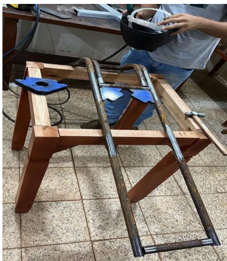
Figura 2 - Alinhamento dos tubos
