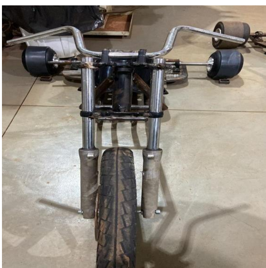
Figura 11 -Visão Frontal da Caixa de Direção
