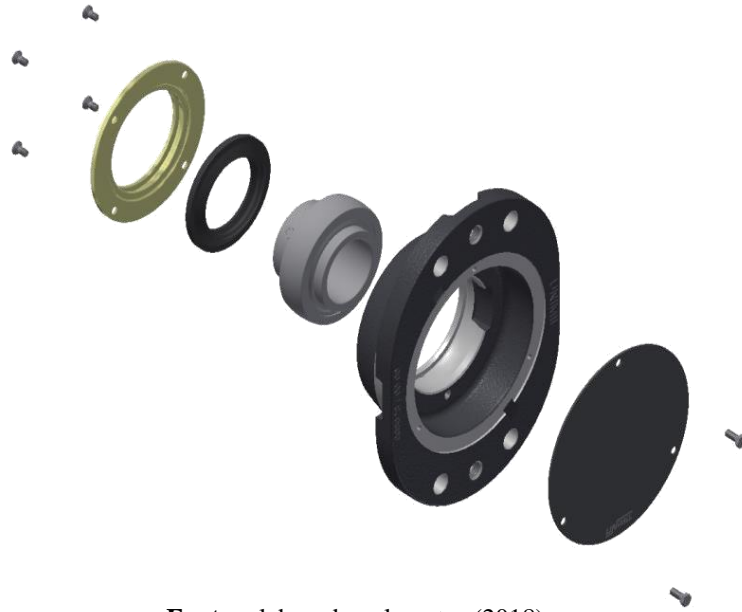
Figura 2 - Mancal original vista lateral esquerda explodida
