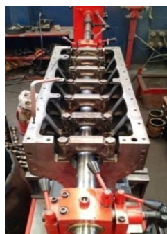
Figura 35 - Mandrilamento mancais do bloco.
