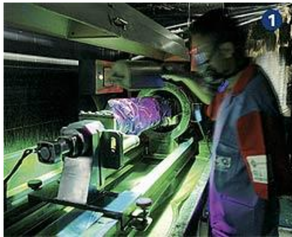
Figura 37 - Verificação de trincas virabrequim, máquina MagnaFlux .
