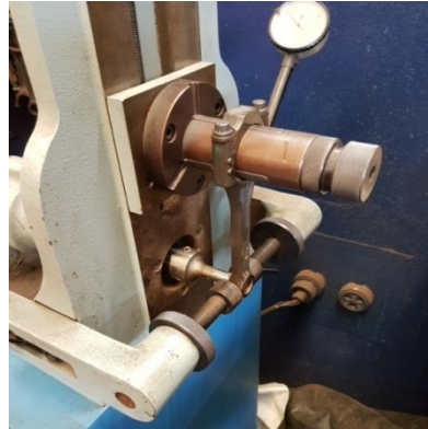
Figura 25 - Mandrilamento da bucha do pino do pistão.
