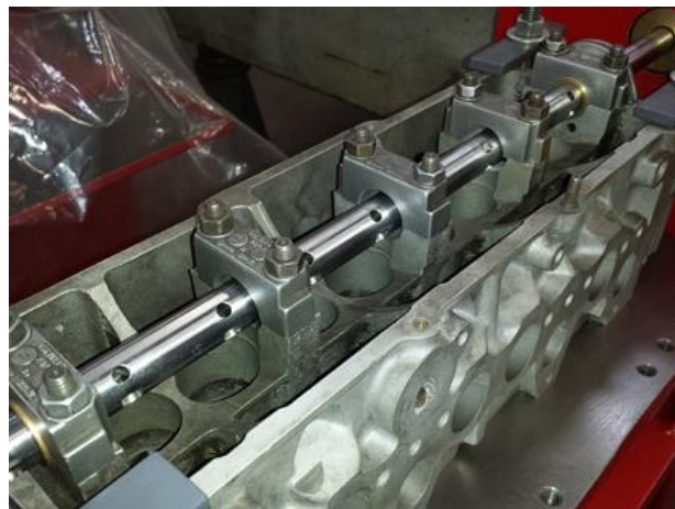
Figura 4 - Mandrilamento do alojamento do comando de válvulas.
