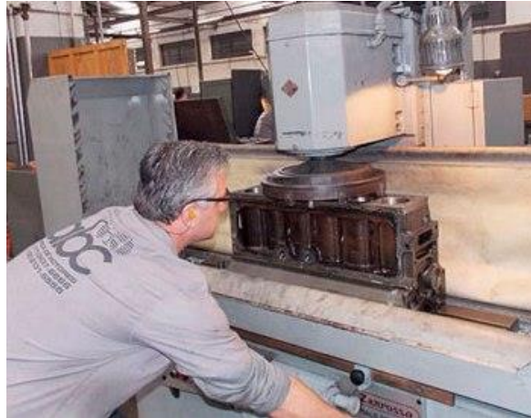
Figura 30 - Processo de plaina da superfície superior do bloco.
