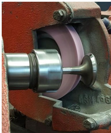
Figura 8 - Retífica de ângulo de assentamento
