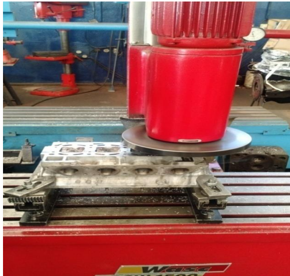
Figura 5 - Processo de aplainamento do cabeçote.
