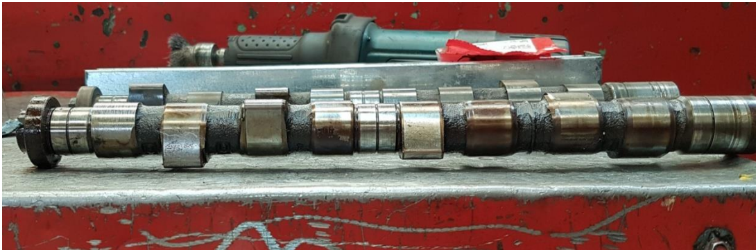
Figura 15 - Comando de Válvulas com desgaste e ovalização.
