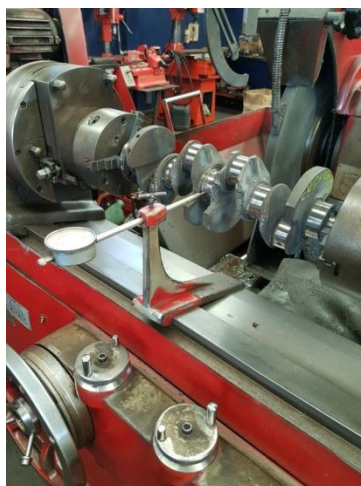
Figura 39 - Verificação do alinhamento, colo por colo.
