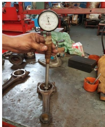
Figura 23 - Verificação do alojamento da biela.
