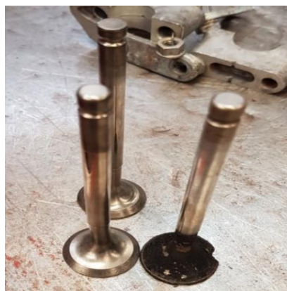
Figura 6 - Válvulas boas e válvula para descarte danificada.
