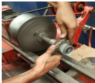
Figura 24 - Lixamento do alojamento da biela.
