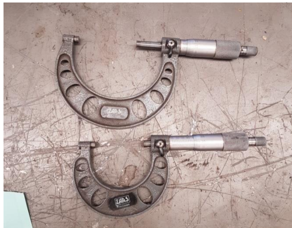
Figura 38 - Micrômetros para medição dos colos dos virabrequins.
