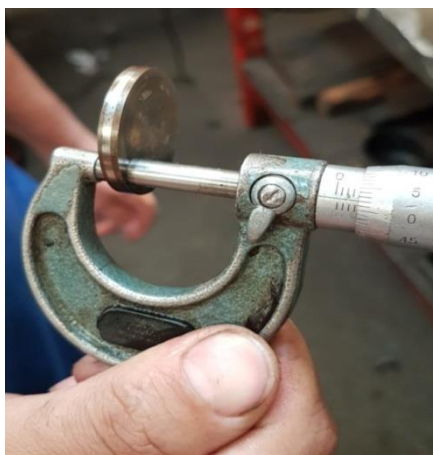
Figura 17 - Medição espessura da Pastilha.
