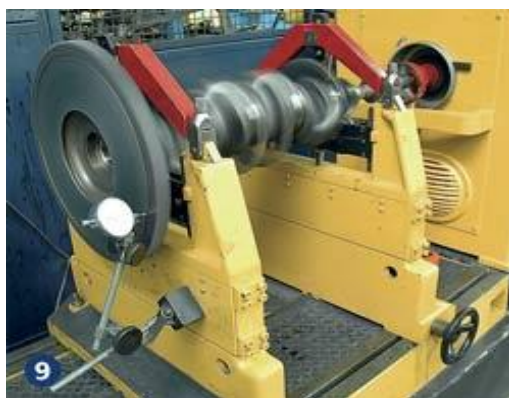
Figura 42 - Verificação de possível empenamento.
