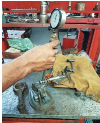
Figura 22 - Passando medida para o Sub.
