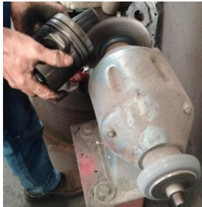
Figura 2 - Pistão passando pela escova de aço rotativa.
