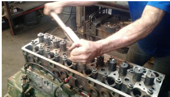
Figura 45 - Dando o aperto (torque) nos parafusos do cabeçote com o torquímetro de estalo.
