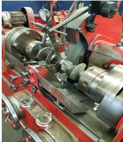
Figura 40 - Processo de retifica do virabrequim.
