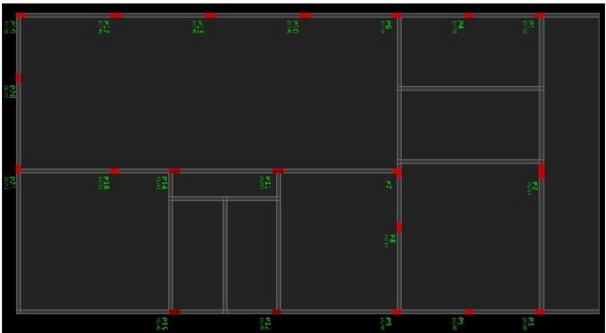
Figura 11 - Posicionamento dos pilares pavimento superior.
