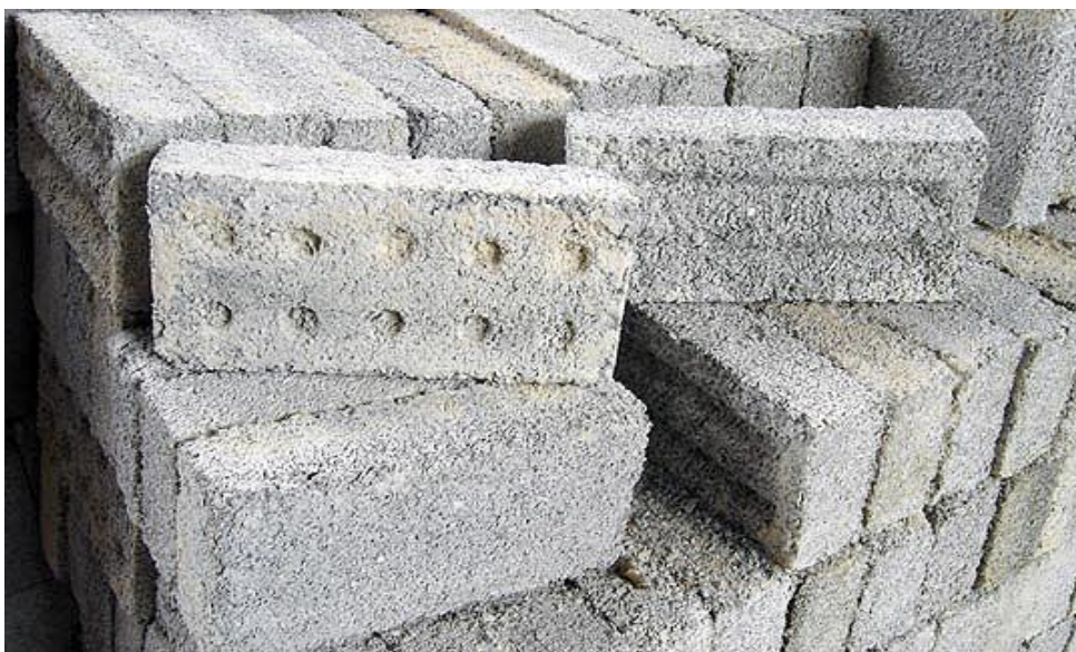
Figura 9 - Substituição de areia por PET em blocos de concreto
