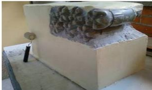
Figura 15 – Disposição das garrafas em parede experimental
