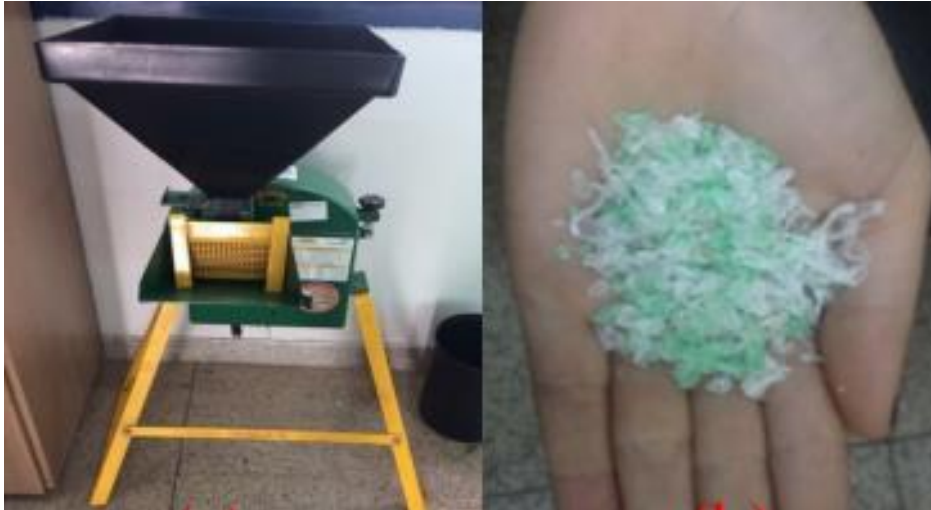
Figura 14 – Triturador de lâmina e PET triturado
